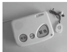
▲緊急通報システムの機器
