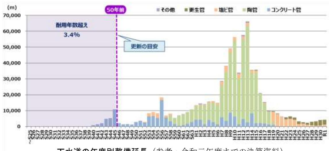
下水道の年度別整備延長（参考：令和元年度までの決算資料）
